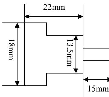
TXM26-XXXX-XX 驱动模块是专为使用 MR16 灯头的 LED 灯具而设计, 可以直接装入通用的灯头中 MR16 中, 可驱动 1\*3W 左右低压的 LED。驱动器是长方形的结构, 温升比较低, 可以长时间的工作。本模块有过流保护, 在异常情况下对 LED 有一定的保护。
