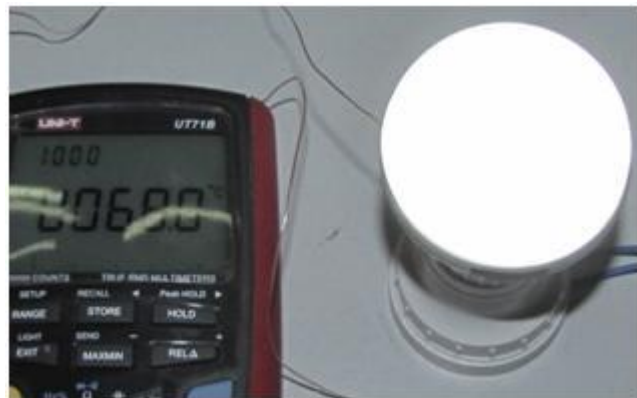
图 12: MX-6 A19 焊点温度测量
