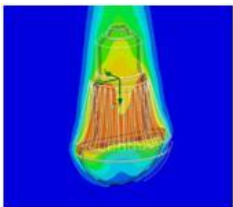
图 3: MX-6 A19 温度热模拟
