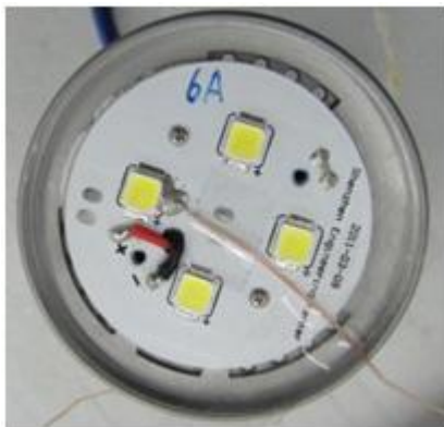
图 11: 装到 MX-6 LED 的热电偶
