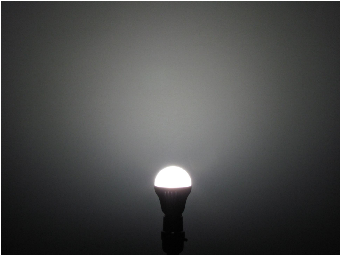
图 16: 白色墙壁背景上的 MX-6 A19 改型灯照明效果
